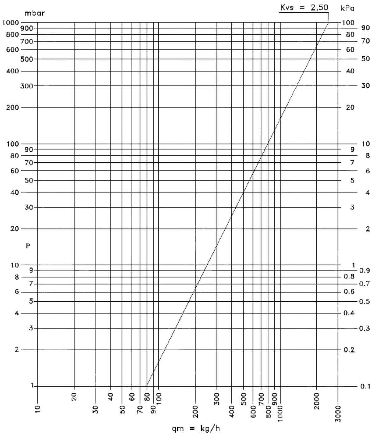
*Kvs* - коэффициент пропускной способности полностью открытого клапана.
